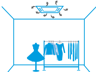
Rozkład powietrza z zabrudzonym filtrem
