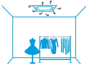
Rozkład powietrza z zabrudzonym filtrem
