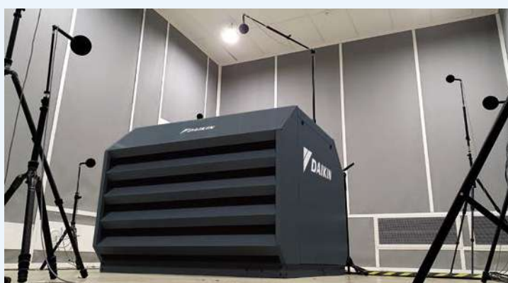
Pomiar poziomu mocy akustycznej w komorze akustycznej
